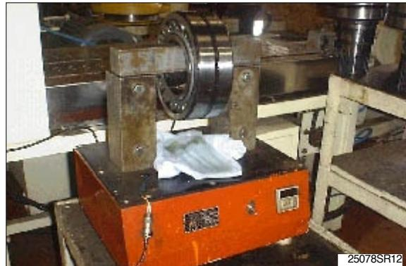
Demagnetize roller bearing(4) using demagnetizing machine.
