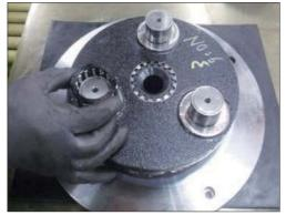
9) Disassemble sun gear No.2 (12).
