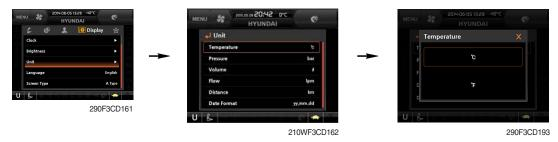
$\cdot \ \, \text{Temperature} \, : \, {}^{\circ}\text{C} \longleftrightarrow {}^{\circ}\text{F}$
