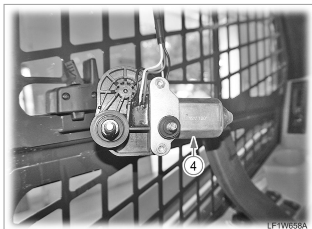
11. Remove the wiper motor (4).
