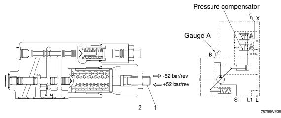
5. EH (electro hydraulic) CONTROL BLOCK
