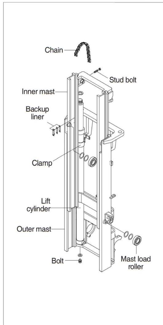
2) 2 STAGE MAST (VF MAST)
