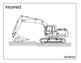
3) OPERATE BREAKER WITH A GAP IN EXCESS OF 100mm(4 inches) FROM THE END OF THE STROKE TIP
